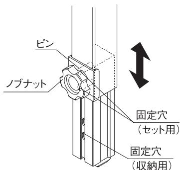
サポートの長さをスライドして調整したのち、下の金具の矢印マークの方向へツメを引っかけるように差し込みます。その時、ロックバーが金具の穴に納まってはずれないことをご確認ください。
