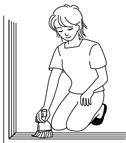
下枠レールの清掃
