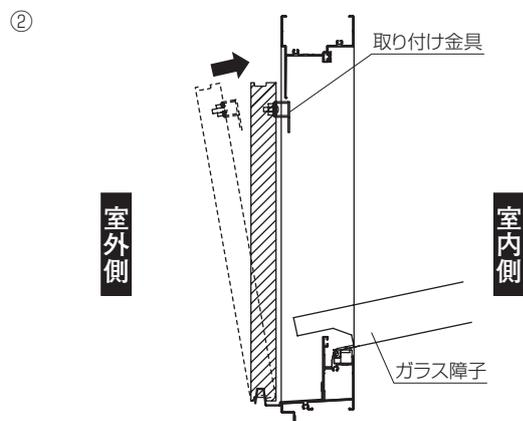
③ 網戸上部の取り付け金具を回転させ、網戸を枠に固定させてください。
