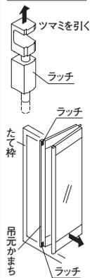
上下ラッチのツマミを引いたまま吊元かまちはたて枠からはずします。
