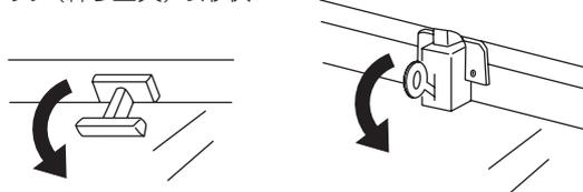
※トップラッチのレバーを下方向へ倒す(回転させる)とロックが解除されます。
