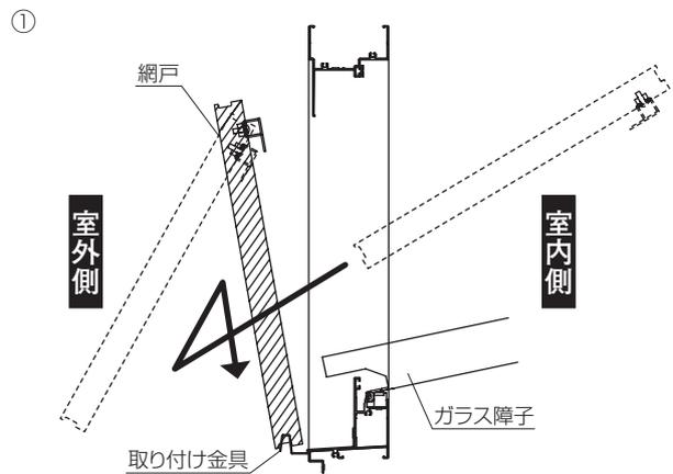
② 網戸上部の取り付け金具を持ち、網戸を枠に引き寄せます。
