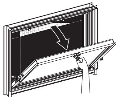
② 網戸固定金具(上)の固定ねじをゆるめ、下方向にスライドしてください。
