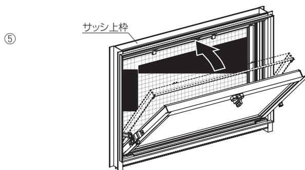
⑥網戸固定金具(上)の固定ねじをゆるめ、上方向にスライドさせ、ねじを締めて固定してください。サッシ枠に網戸が固定されます。
