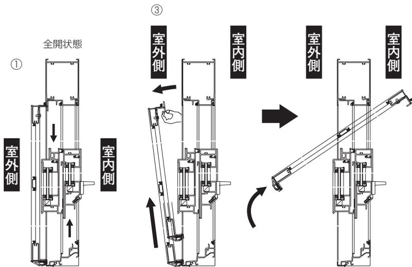
③網戸上部を室外側に押し出してから、網戸両サイドのたてかまちに持ちかえます。網戸下かまちはレールからはずし、室内側に取り込みます。
