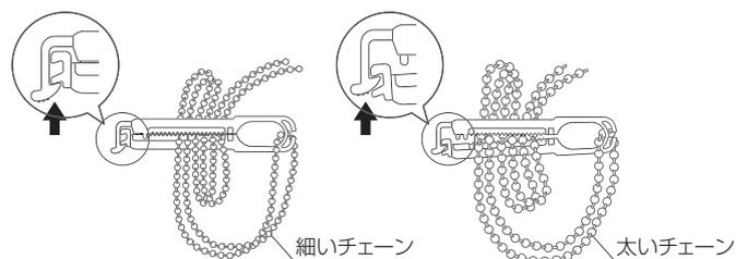
④網戸を操作する際は、コードクリップ先端のレバーを広げ、ロックを解除し、チェーンコードを降ろし、コードクリップのロックをかけてから網戸を操作してください。
