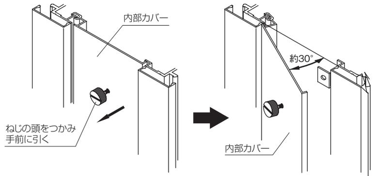
③カバーを開け、換気装置の網戸ネットの汚れを掃除機で吸引してください。掃除機を使用する際、すき間用ノズルなど先の細いもので吸引すると効果的です。
