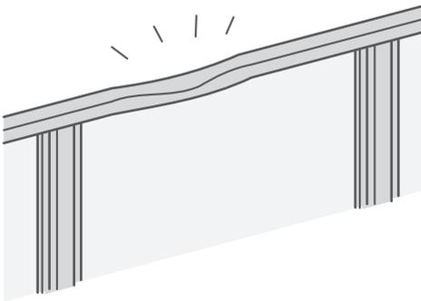
④ 二段笠木・下弦材が変形している。
