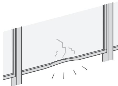
⑤ 手すり子が変形している、はずれている。
