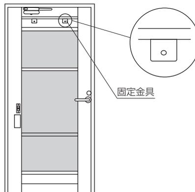
② 室内側から上部2ヶ所の固定金具の網戸固定用ねじをドライバーでゆるめ、はずします。
