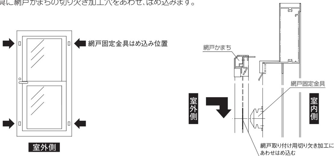
② 室内側から上部2ヶ所の固定金具を網戸固定用ねじで締めます。
