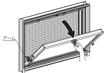
② 網戸固定金具(上)の固定ねじをゆるめ、下方向にスライドしてください。
