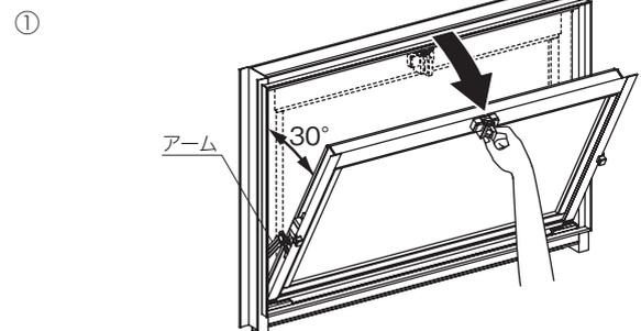
②全開状態の窓を手で支えながら、ガラス障子の左右のツマミを上げてください。アームが二段階開放し、さらに窓が開きます。
