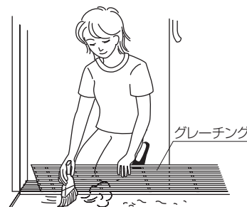
排水溝の清掃
