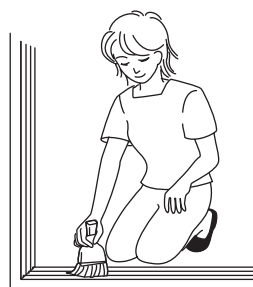
下枠レールの清掃
