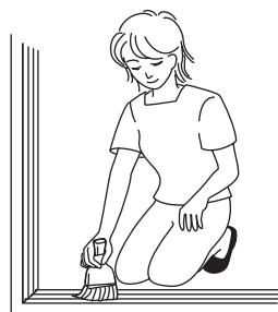
下枠レールの清掃
