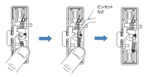
(注意) ラジオペンチなどで**ばね**を引っ張らないでください。**ばね**に傷がついたり変形すると、 破損しやすくなります。
