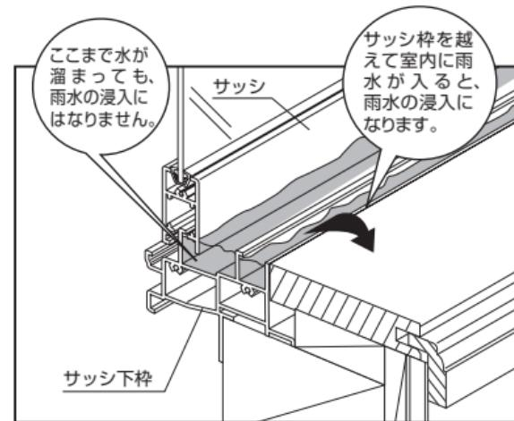
※雨水の浸入の判断基準は、サッシ枠を超えて室内に雨水が入ってくることであり、サッシ下枠内に水が溜まることは室内への浸入とはなりません。
