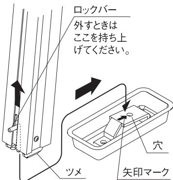
●下の金具の矢印マークの方向へツメを引っかけるように差し込みます。その時ロックバーが金具の穴に納まって、はずれないことをご確認ください。
