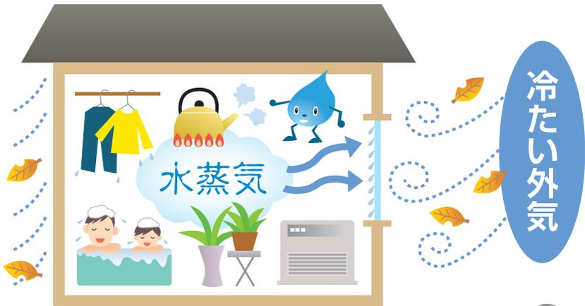
室内の空気に含まれる水蒸気は、温度が一定以下になると結露ははじめます。その時の温度を露点温度といいます。窓の表面温度が露点温度より低い時、窓の表面に結露が発生します。
