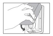
⑧カバーを取り付けてください。 カバーの突起を電動サムターンに引っ掛けてください。
