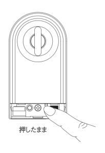
④下部電動防犯サムターンのカバーを取り付けます。
