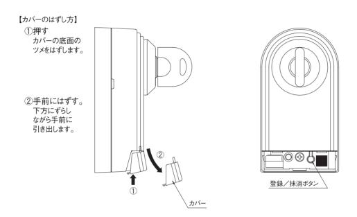
③登録/抹消ボタンを押したままの状態を5秒間保持してください。 「ピー」と1回音がして、シリンダーの動作表示ランプ(緑色)が点灯し全てのリモコンキーの登録が抹消されます。
