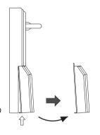
押す(押し上げる)電池カバーの底面のツメをはずします。
