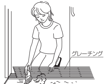
排水溝の清掃
