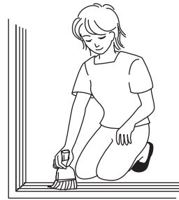
下枠レールの清掃
